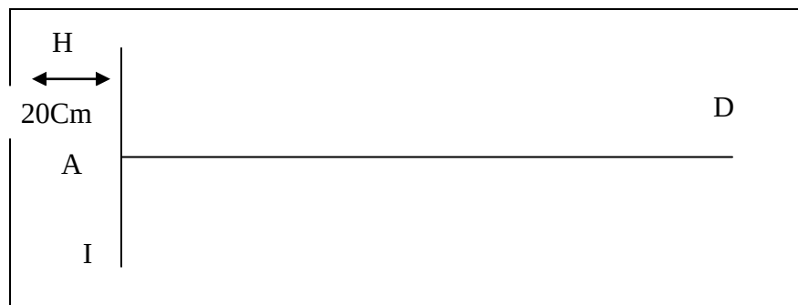
شکل ۱- شمایی از نحوه علامتگذاری برای اندازه گیری حرکت سرکجی (قبل از شستشو)
